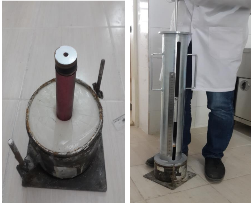
Şekil 3.25. Model kazıkların çakılması
