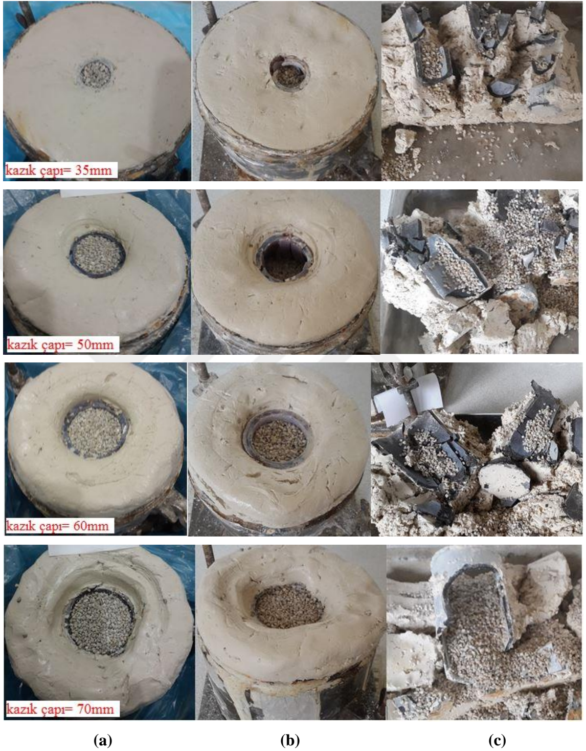
Şekil 4.11. İçi boş kırmataş dolgulu kazıkların kazık yükleme deneyi görüntüleri
