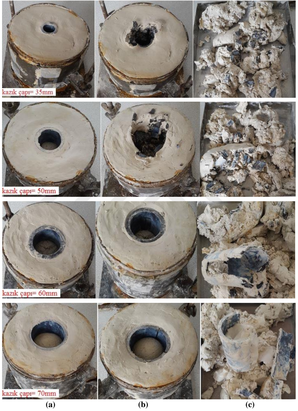
Şekil 4.3. İçi boş kazıkların kazık yükleme deneyi görüntüleri
