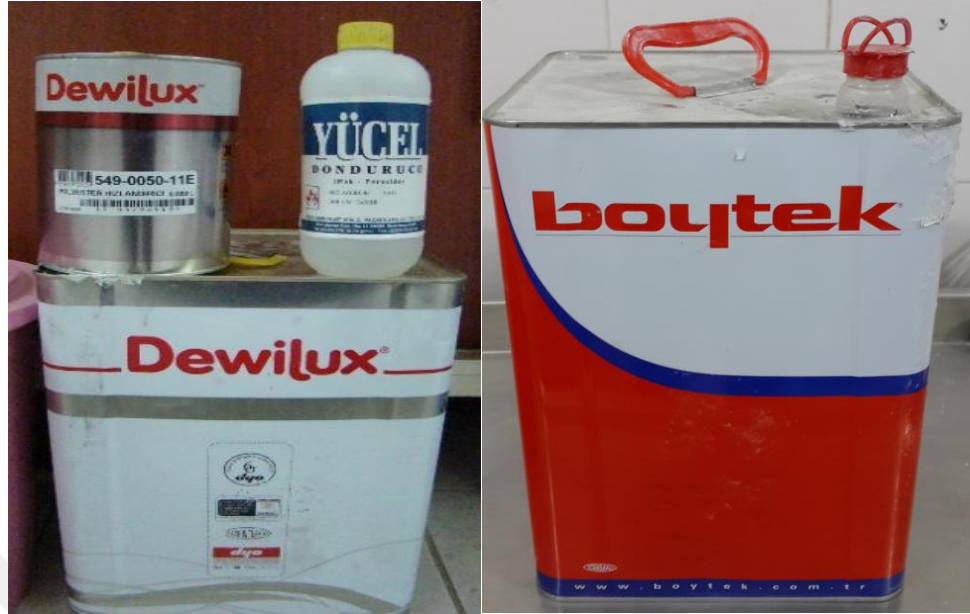
Şekil 3.3. Doymamış polyester, polyester hızlandırıcısı ve sertleştiricisi
