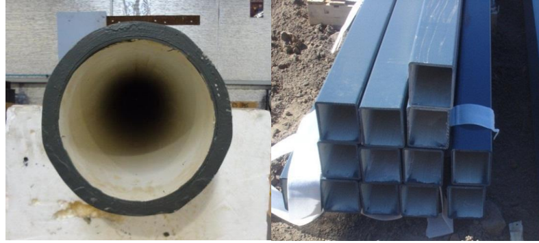
Şekil 2.2. Dairesel ve kare kesitli içi boş kazık (Guades 2013)
