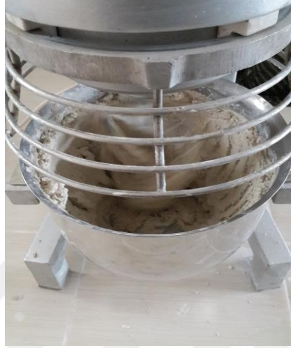
řekil 3.11. Mikser ierisinde hazırlanan yumuřak kil numunesi
