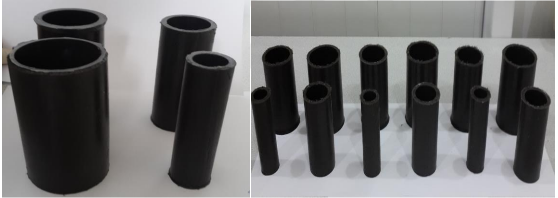
Şekil 3.7. Kalıplardan çıkarılan kazıklar
