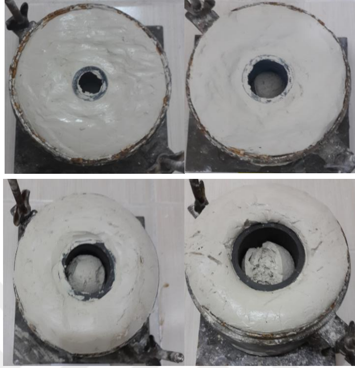
Şekil 3.26. Farklı çaplardaki kazıkların çakmadan sonraki görüntüleri
