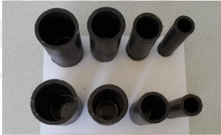
Şekil 3.23. İçi boş-altı kapalı kazıklar
