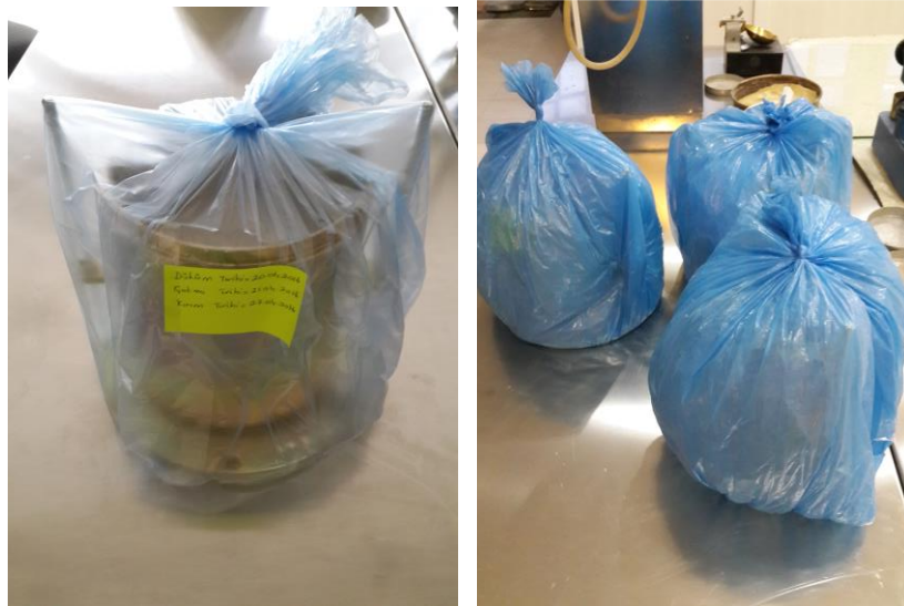
Şekil 3.14. Model kalıplar içerisinde zeminin bekletilmesi
