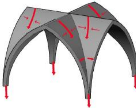
Şekil 2.7. Çapraz tonoz yük aktarımı
