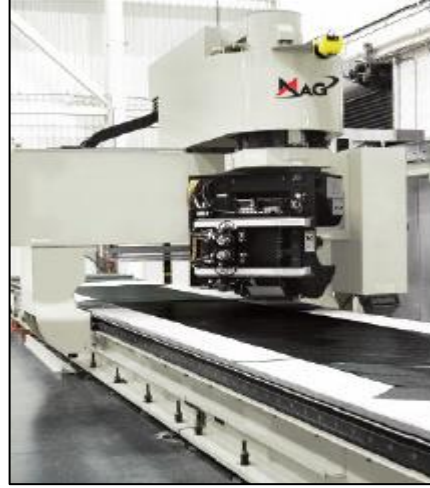
Şekil 2.20. Prepreg üretim yöntemlerinden otomatik şerit yatırma
