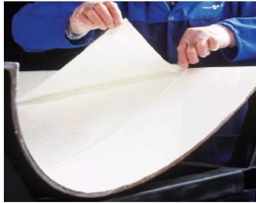
Şekil 2.19. Prepreg üretim yöntemlerinden elle yatırma
