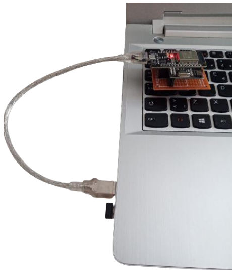
Şekil 2. Bilgisayar sistemine entegre edilmiş sinyal alıcı devre (121E424 nolu proje arşivi)
