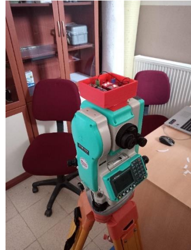
Şekil 6. Eğimölçer ve total station ölçme yöntemlerinin eşzamanlı kullanımı (121E424 nolu proje arşivi)
