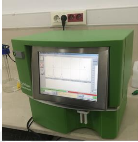
Şekil 4.12. Kallus örneklerinin ploidi seviyelerinin belirlenmesine dair aşamalardan birinin ve bu analiz için kullanılan flow sitomeri cihazının görüntüsü
