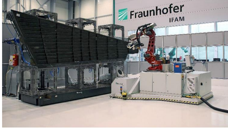
Şekil 23. Havacılık ürünlerini işlemek için SKR kullanımı (Kim et al., 2019)
